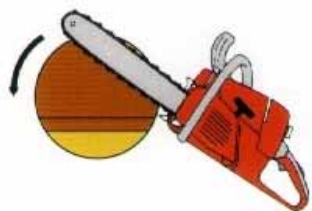
Esecuzione taglio di abbattimento
