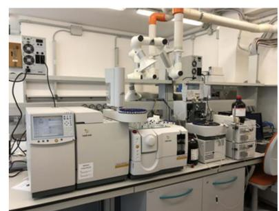
Figura 9 - Gascromatografo
