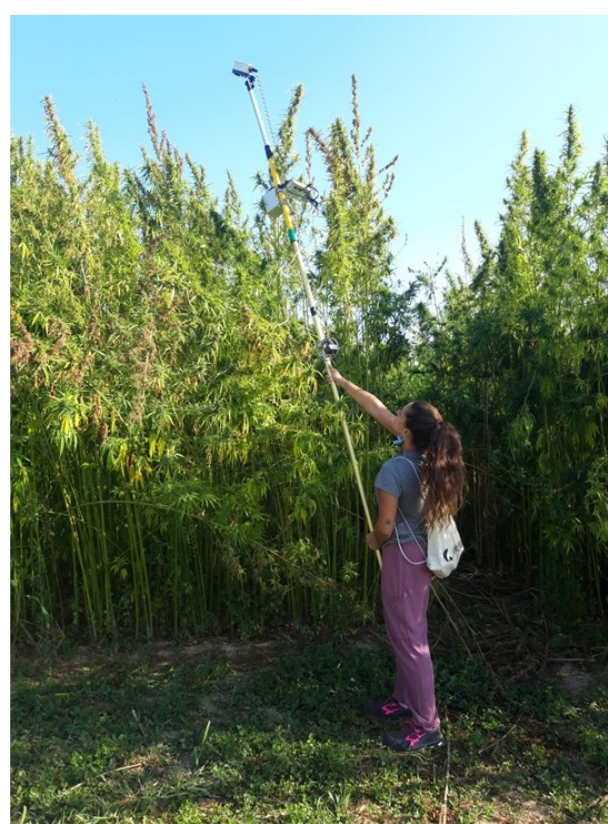
Fig. 2 - Rilievo con Crop Circle
